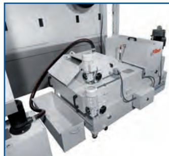
Todo tipo de depósitos de refrigeración y filtración del líquido de corte.
