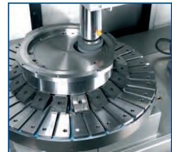
Eje C para el rectificado de piezas no cilíndricas.
